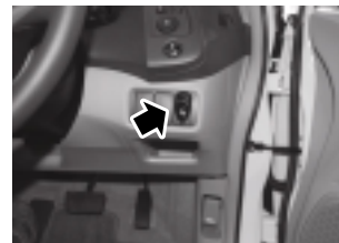
両面テープ張り付け位置は脱脂した後 貼付けてください。
