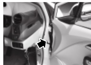
運転席足下の側面のブーツ部より 中継コードを通して下さい。
